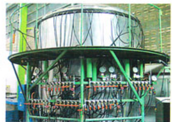
การทดสอบความทนความดัน Hydrostatic Pressure Test
