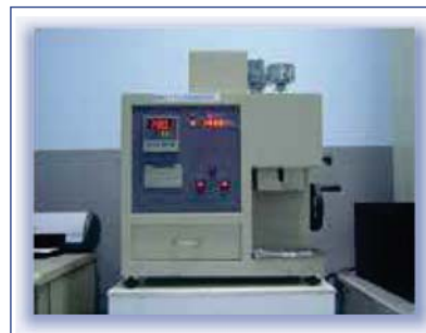
▶ Melt Flow Indexer ทดสอบอัตราการไหล ณ จุดหลอมเหลว
