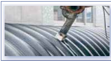
➡ ใช้ลวดเชื่อม 3.5 - 4 mm.
