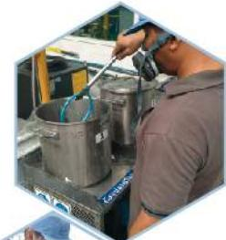
**การทดสอบความทนแรงดันน้ำ (Hydrostatic pressure test)**
